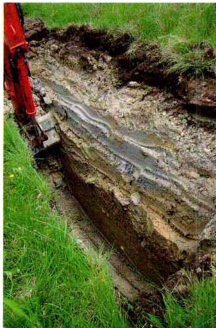
Stânga: Șanț de test la un proiect de permacultură din Tailanda (lut argilos). Dreapta: Șanț de test pentru un proiect BERTA de permacultură în Ausseerland (Austria). Straturile se pot vedea clar (humus, pietriș și lut).
