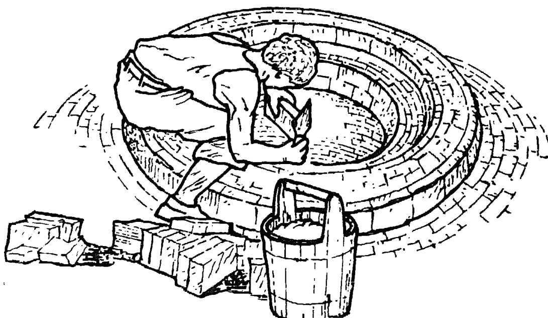
Fig. 4-12. Construirea gurii fosei din cărămizi, fără suport.
