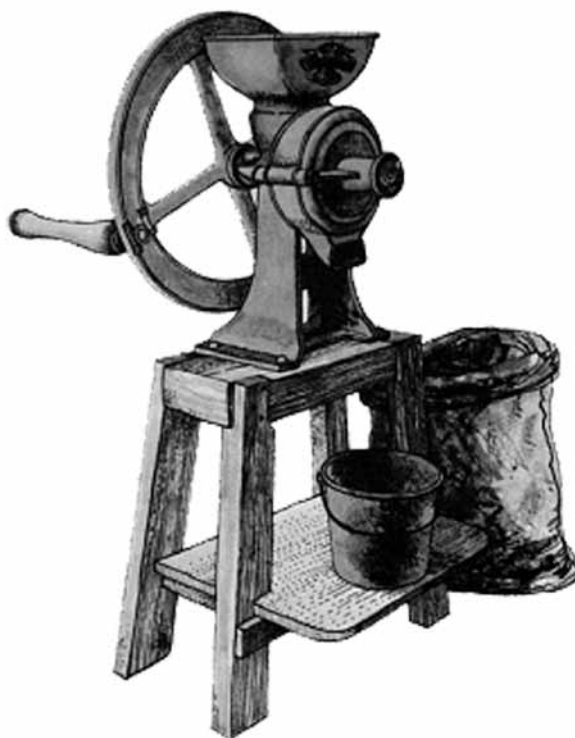
Această moară manuală cu caneluri este suficientă pentru o familie mică și produce o făină fină. O moară cu pietre poate fi ceva mai bună, dar vă trebuie mai multă îndemânare pentru a o monta și a o utiliza.
