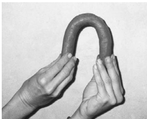
2.2: O argilă de calitate poate fi modelată cu foarte puține fisuri.
