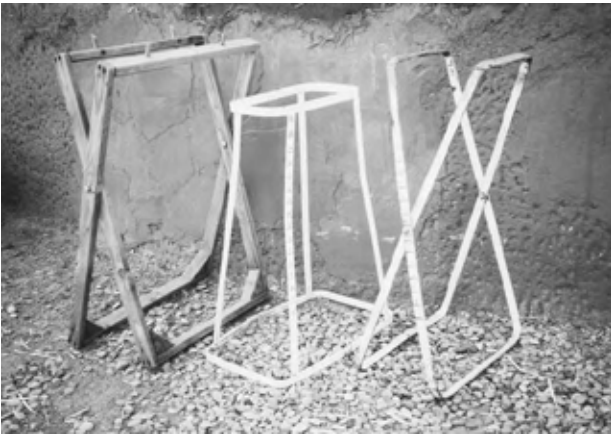
3.2: Varietatea evolutivă a stativelor pentru saci. De la stânga la dreapta: lemn pliabil; metal rigid sudat; și preferatul nostru, cel pliabil fără sudură.
