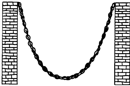
10.11a (sus): Lanțul atârnat între două puncte creează o curbă catenară, un arc în tensiune completă.
