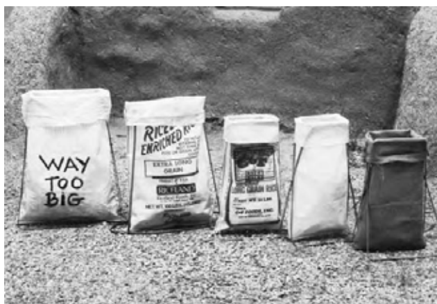
2.12: Câteva tipuri de saci (de la stânga la dreapta): mult prea mare, 50 kg imprimat greșit, 25 kg imprimat greșit, 25 kg cu clini imprimat greșit, 25 kg din pânză de sac.
