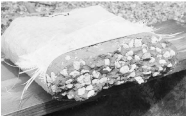
4.16: Sac de pământ cu piatră ponce întărit și aplatizat, componentele sunt compresate împreună la fel ca la un amestec tipic de pământ bătătorit.
