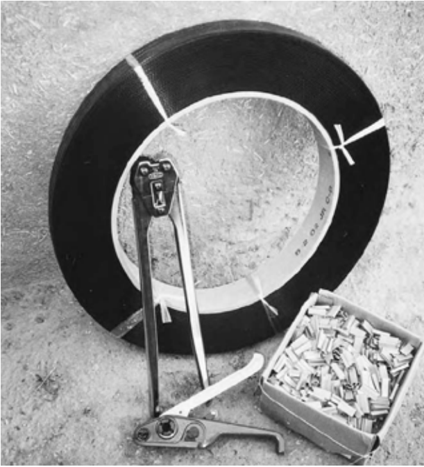
9.12: Ansamblul instrumentelor de legat. Clește pentru tensionat, 390 m sul de bandă (cu rezistență la 272 kg forță), cleme și clește pentru sertizare, costă aproximativ 130 dolari. Comparați totul cu prețul unei grinzi din beton.
