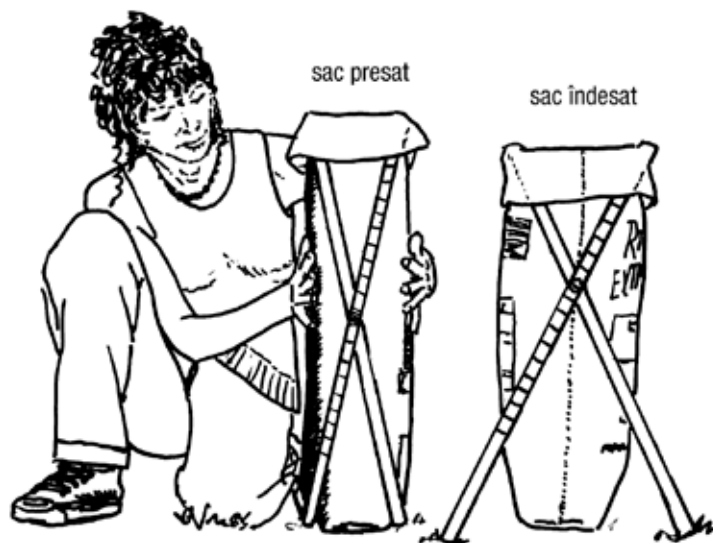
3.39: Exemple cu un sac îndesat și un sac presat prin alunecare.
