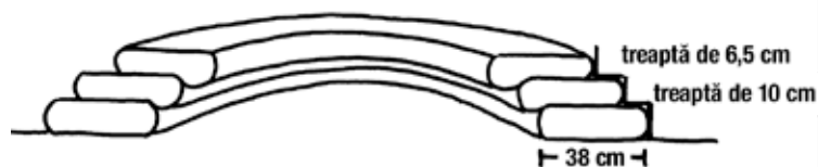
12.1: Test de simulare a curbării făcut pe sol cu tuburi de 38 de centimetri lățime. Exersați tehnica așezării în straturi decalate și testați modul de comportare al pământului vostru.
