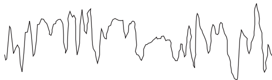
Figure 6-18 Actual 1000BASE-T Signal
